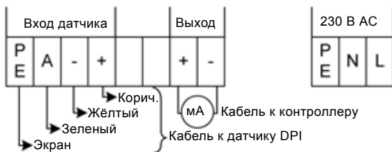
Рис. 5 Электросхема для подключения усилителя
